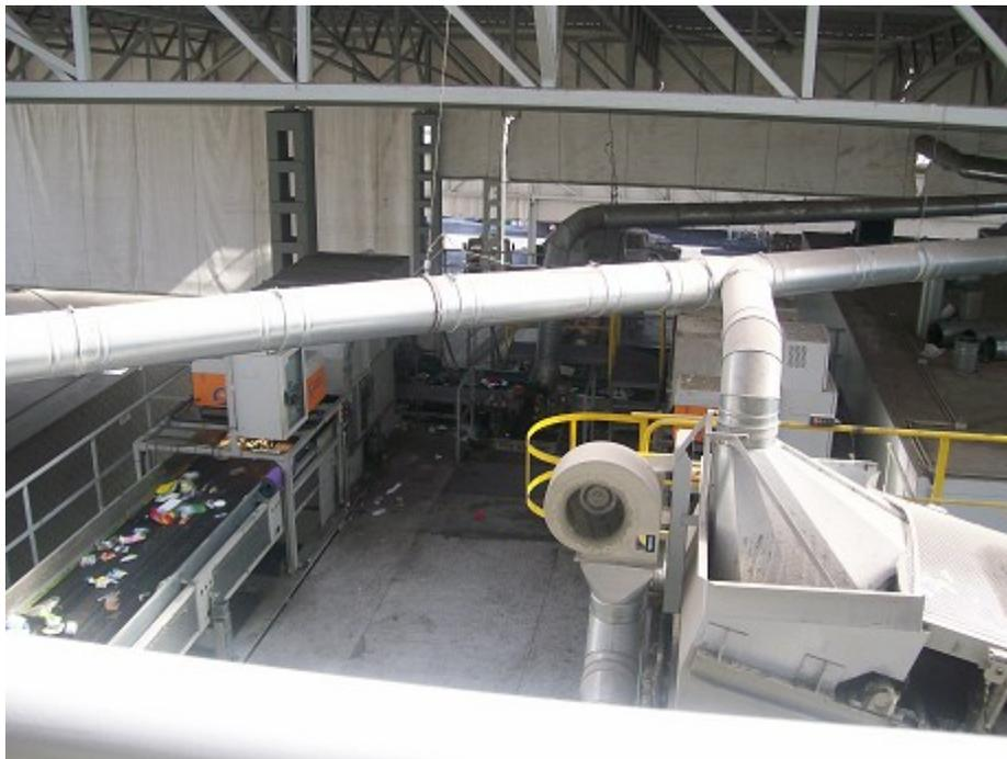
Vista general. En el sector izquierdo, se puede apreciar la cinta de clasificación que utiliza separador óptico
